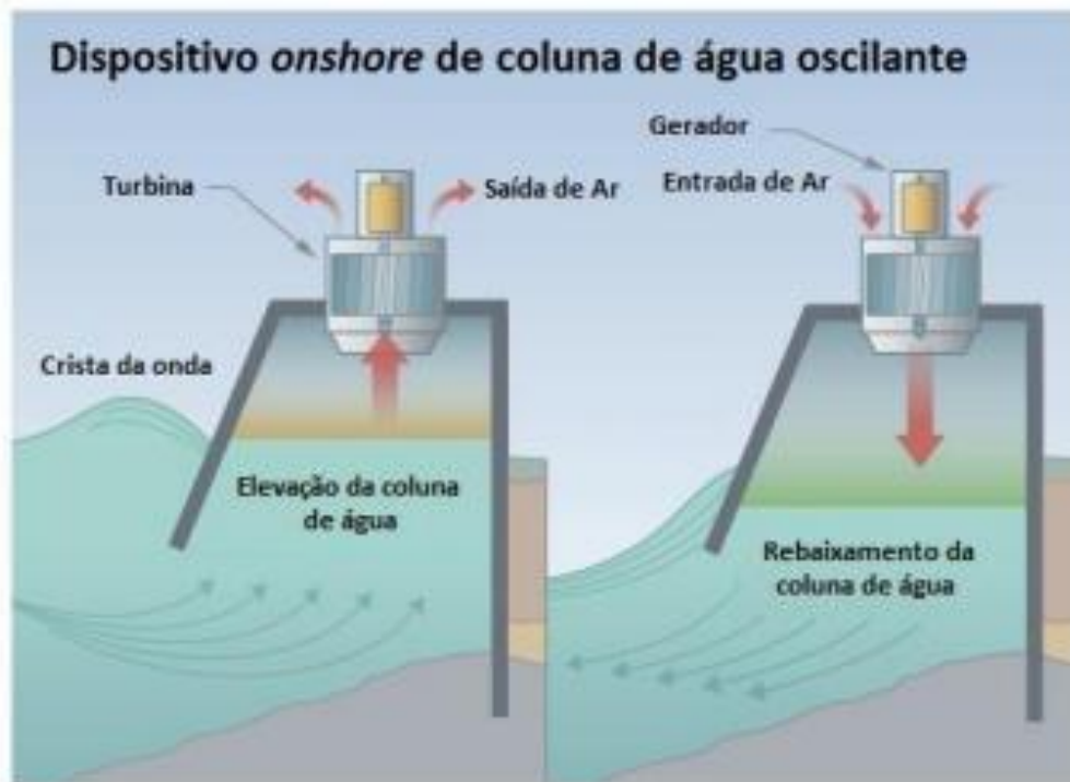
Figura 9 – Princípio de funcionamento de dispositivo de coluna de água oscilante para aproveitamento da energia das ondas
