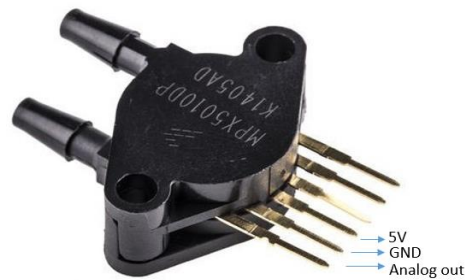
Figura 20 - Sensor de pressão MPX5010DP
