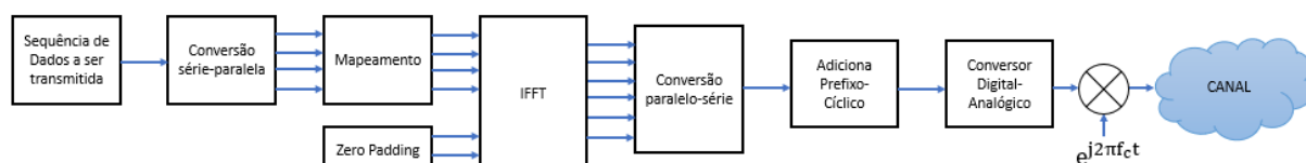
Figura 5 – Configuração de um transmissor OFDM
